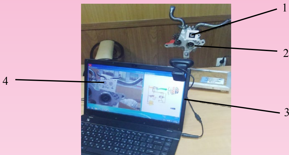
1 – маркер дополненной реальности, 2 – реальный объект, 3 – виртуальный аналог реального объекта, 4 – интерфейс приложения в целом
